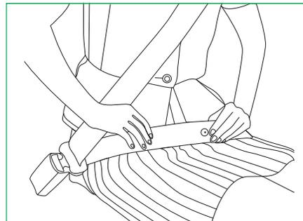
Você deve apoiar o cinto de segurança na região do quadril, não na cintura. Se o cinto de segurança for colocado em uma região mais alta do corpo durante um acidente ou uma frenagem de emergência, seu corpo pode escorregar para fora dele e o risco de ferimentos aumenta. Não coloque as mãos no mesmo lado do cinto de segurança, e as mãos devem estar em ambos os lados do cinto de segurança.
